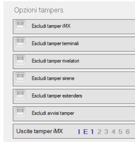
La programmazione “Opzioni Tamper” permette di abilitare o escludere dagli allarmi i tampers selezionati.
