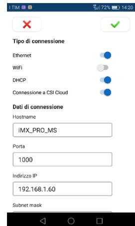
Le centrali iMX Pro MS se dotate dell'apposito modulo radio possono utilizzare il WiFi per collegarsi con il mondo esterno. Attivando il WiFi si creerà un WiFi privato che consente ad un PC o allo smartphone di collegarsi direttamente alla centrale per le operazioni di programmazione
