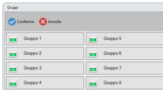
Abbinamento della sirena ai Gruppi del sistema: la sirena suona allarme quando uno o più linee/canali dei Gruppi abbinati è in allarme.
