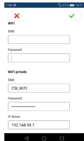
Se necessario i parametri del WiFi privato possono essere cambiati, specialmente il canale, nel caso ci fossero dei disturbi dovuti a più Access Point operanti sullo stesso canale.
