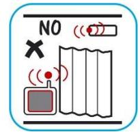
Evitare l'installazione in prossimità di altre apparecchiature radio
