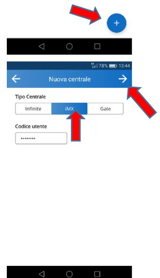
Scegliere come tipo di centrale da creare "IMX", premere la freccia in alto a destra per proseguire (il codice utente di default viene aggiunto automaticamente, potrà essere cambiato in seguito)
