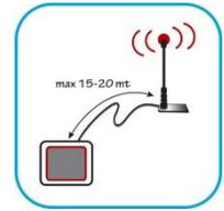
L'antenna esterna potrebbe essere utile anche nel caso in cui ci fossero dei problemi sulla ricezione del segnale dei telecomandi in concomitanza con la trasmissione del combinatore GSM/4G. In questo caso il segnale del combinatore può saturare temporaneamente il ricevitore Wlink per cui potrebbe essere necessario spostare una delle due antenne se si devono utilizzare i telecomandi mentre il combinatore sta trasmettendo.
