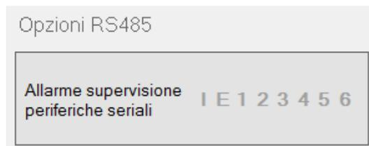
**Allarme supervisione periferiche seriali:** uscite attivate in caso di assenza comunicazione con le periferiche RS485 (IPlus, rilevatori RS, sirene RS).
