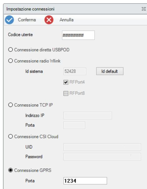
Gli unici parametri da inserire sono, nel campo Codice Utente di accesso per le connessioni GPRS, un codice numerico tra quelli presenti in iMX che sia abilitato alle operazioni che intendiamo eseguire sul sistema (programmazione, visione memoria, impostazione dell'orologio calendario) e nel campo Richiedi connessione in modalità server su porta, il numero di porta assegnata al PC (chiedete informazioni al vostro Amministratore di rete).
